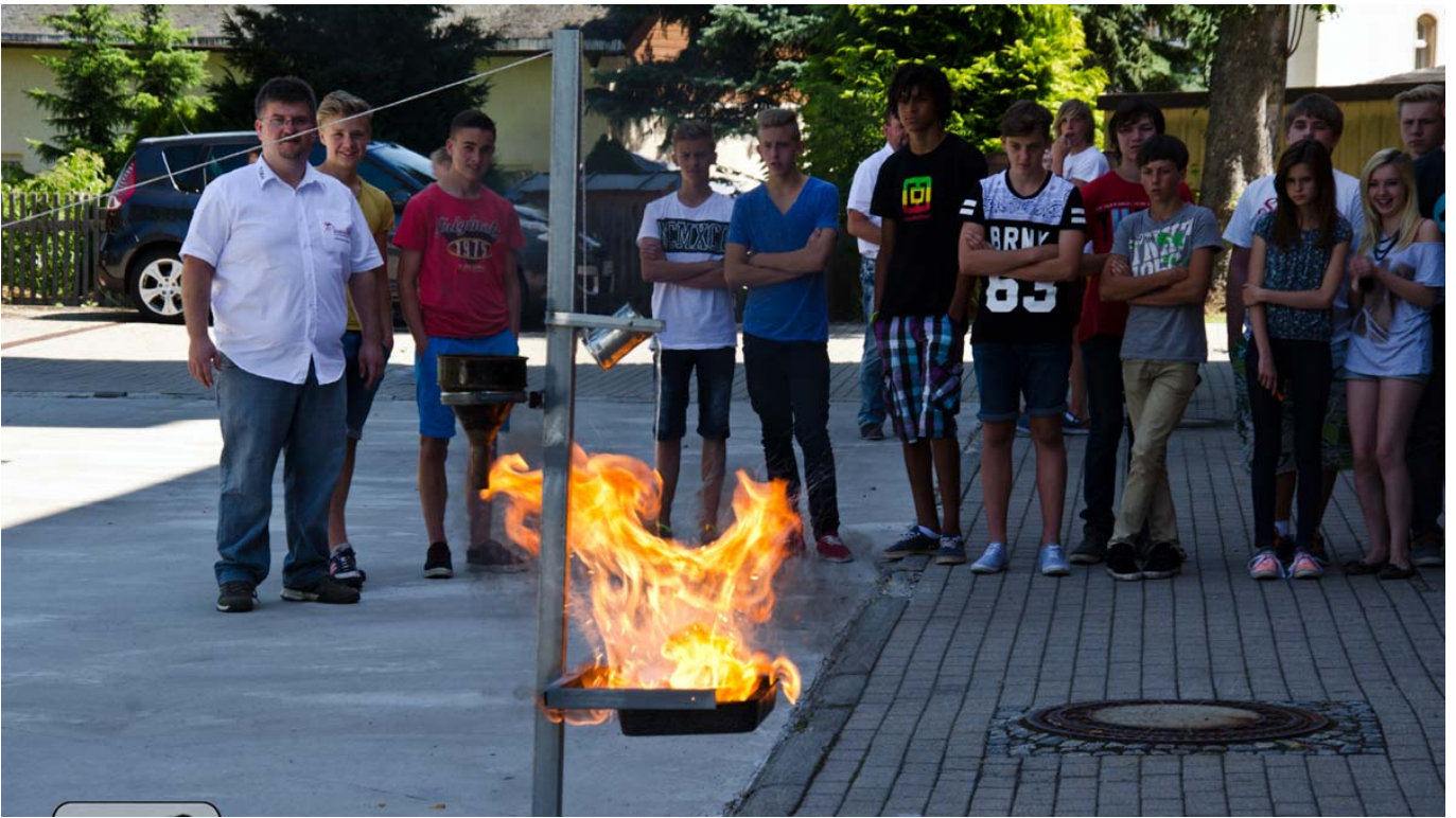
_ Experiment: Fettbrand mit Wasser löschen (wollen) - Bildrechte: Lukas Ullmann
